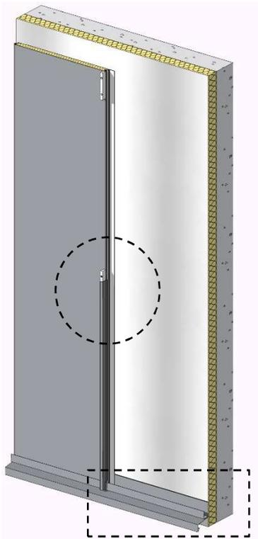
Le **guide** permet l'alignement des profils joint debout et facilite le maintien du profil avant la pose du revêtement suivant.
