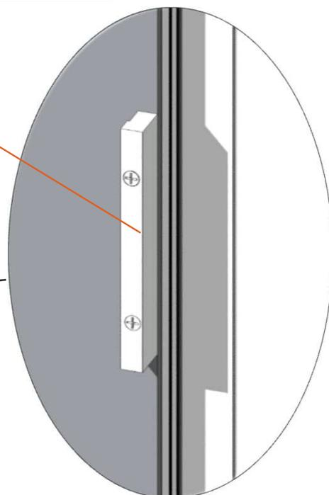
La fixation des guides est réalisée grâce à une vis auto-foreuse à tête plate pour aluminium  $\varnothing$  4 mm maxi et profondeur 30 mm.
