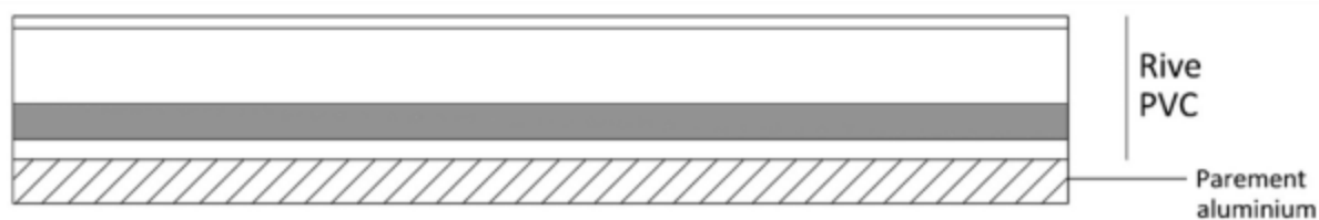
1. Coupe horizontale > Pose horizontale Panneau avant façonnage
