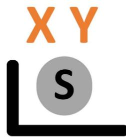
La somme des longueurs X + Y doit être comprise entre 40 et 487mm.
