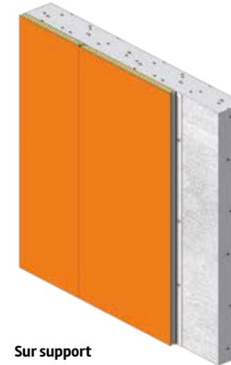
Sur support béton ou maçonnerie
