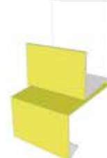
Profil n°4 : jonction horizontale (associé à une finition) 5/10 e - 7/10 e
